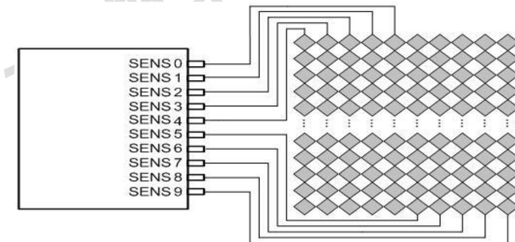
**注：** 如果为配合已有的sensor,而产生多余的感应通道，可直接悬空。为使输出坐标与物理坐标匹配，需要配置GT818的相关寄存器来保证各感应通道的逻辑位置关系与物理位置关系一致。
